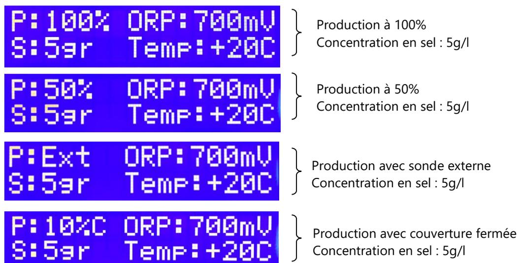
Figure 9 - Exemple de menus avec indication de production de chlore
